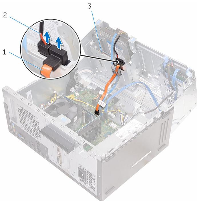
1 podatkovni kabel za optični pogon
